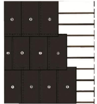
Figura 1. Colocación de las placas
