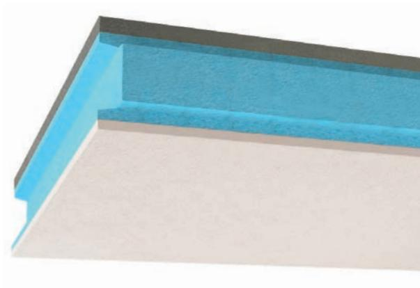
**THERMOCHIP ROOF** es un panel para **cubiertas planas**, colocado sobre una estructura portante y formado por un tablero interior de fibro-yeso, un núcleo aislante continuo de poliestireno extruido machihembrado a cuatro caras y un tablero de fibro-cemento en la cara superior. Se presenta en versión estándar o versión PLUS, con una lámina impermeable transpirable adherida.
