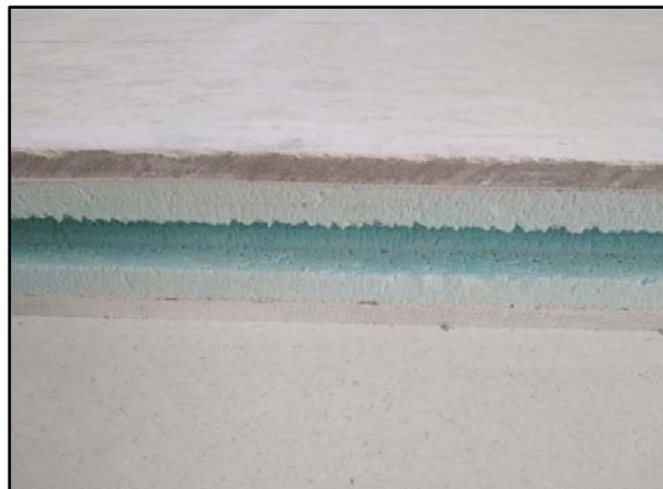
Zona de la hembra y del canto del panel TFbcY / 12-60-12
