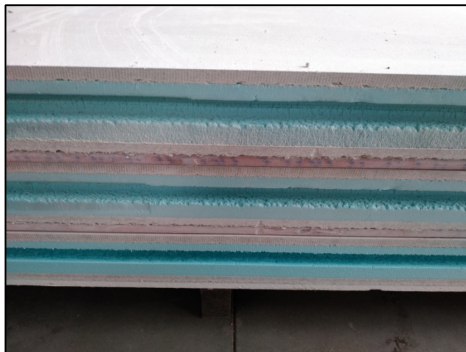
Vista del canto y zona de hembra del panel TPFYY / 15-12-60-12
