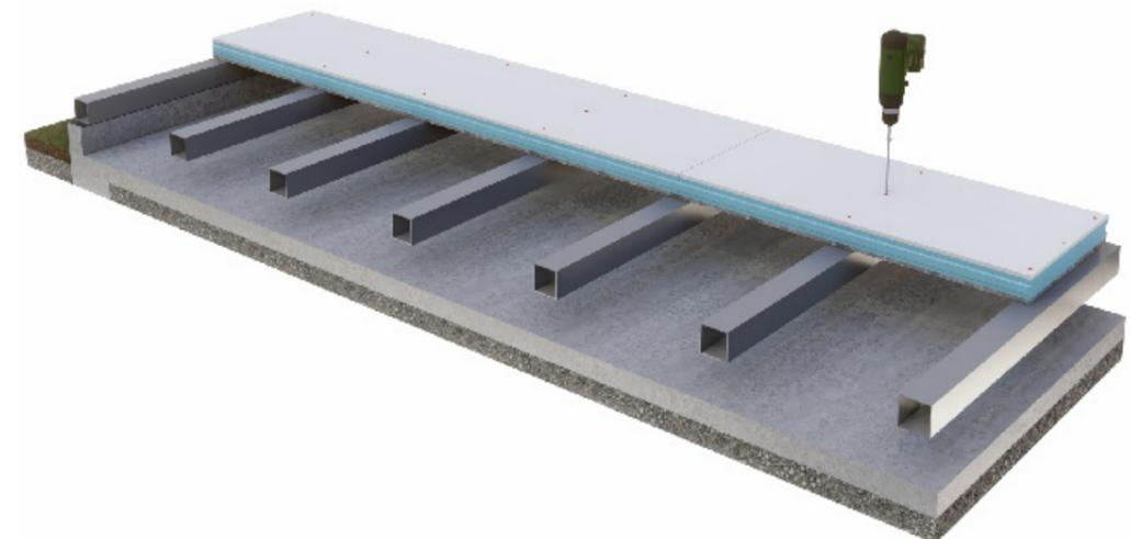
**Paso 4.-** Antes de colocar los paneles de la segunda fila, se aplica pegamento en la cara de la placa de fibroyeso de los paneles ya fijados.
